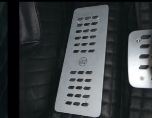
XJ-819-10 ALUMINIUM FUSSSTÜTZE ALUMINIUM DEAD PEDAL - FOOT REST
